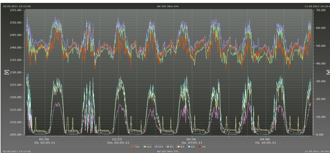
Tensions et courants en triphasé
