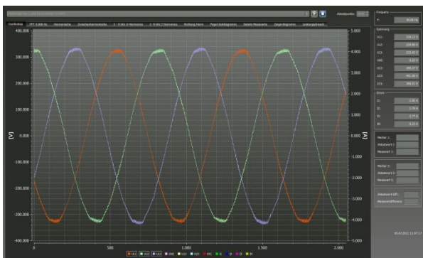
Oscilloscope, 20,48 kHz de bande passante, en ligne
